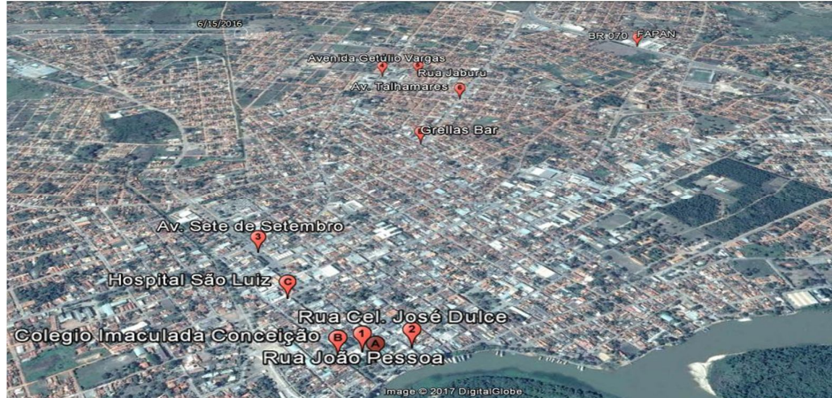
Figura 61: Localização dos pontos de coleta de dados de ruído na malha urbana de Cáceres. O Quadro 3 mostra os dados de contagem do tráfego e nível de ruído medidos in loco com equipamento especializado. As amostragens são de 10 minutos, no circuito de resposta rápida “Fast”, ponderada na curvatura A, aferindo então o L_{Aeq,10} minutos.
