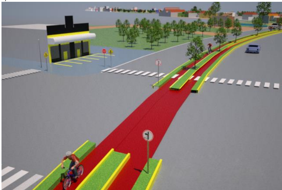
Figura 3.65 – Perfil da ciclovia a ser implantada na avenida Santos Dumont, esquina com a rua Olavo Bilac (academia PowerFit), com detalhes da sinalização vertical, no sentido bairro/Centro.
