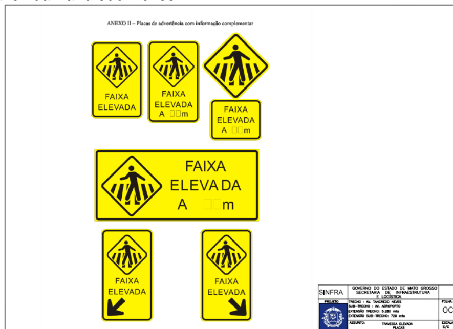
Figura 3.48 – Placas de advertência com informação complementar propostas para a avenida Tancredo Neves.
